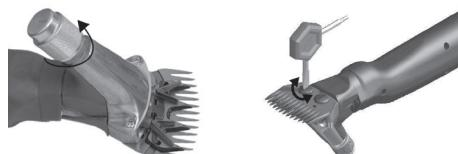
Legg den nye overkniven inn i føringsspissen på svingstangen, deretter drypper du litt olje på den slipte flaten. Så skyver du den nye underkniven mellom de løste skruene.
