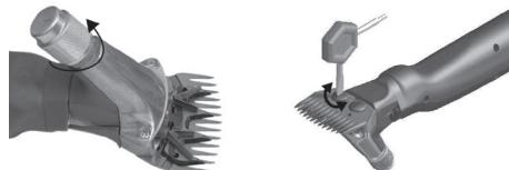
Legen Sie das neue Obermesser in die Kegelstifte der Druckstücke, danach geben Sie einige Tropfen Öl auf die geschliffenen Flächen. Nun schieben Sie das neue Untermesser zwischen die gelösten Schrauben.
