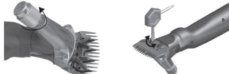
Coloque la nueva cuchilla superior en las puntas guía de la palanca giratoria, echando después algunas gotas de aceite en las superficies afiladas . Ahora desplace la nueva cuchilla inferior entre los tornillos aflojados.
