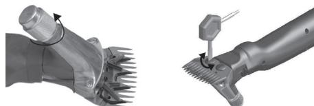
Læg den nye overkniv ind i drejestangens føringsspids, dryp så et par dråber olie på den slebne flade. Nu skubber De den nye underkniv ind mellem de løsnede skruer.
