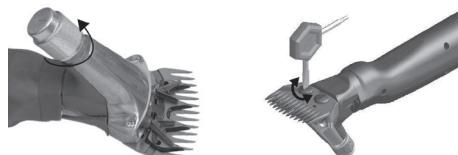
Aseta uusi yläterä vaappuvivun ohjausteriin. Pane tämän jälkeen muutama tippa öljyä teroitetuille pinnoille. Työnnä nyt uusi alaterä avattujen ruuvien väliin.
