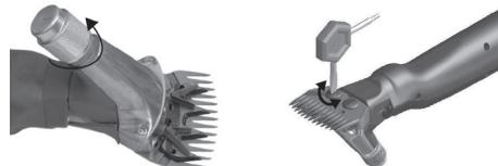
Placez la nouvelle lame supérieure dans les pointes de guidage du levier pivotant, et appliquez ensuite quelques gouttes d'huile sur les surfaces affûtées. Insérez maintenant le nouveau peigne inférieur entre les vis desserrées.
