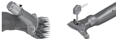
Coloque a nova faca superior nas pontas de guia da alavancinha móvel, em seguida ponha algumas gotas de óleo nas superfícies amoladas. Após, introduza a nova faca inferior entre os pinos afrouxados.
