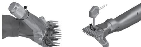
Lägg den nya överskär i svängspakens styrspetsar, placera sedan några droppar olja på de slipade ytorna. Skjut nu in den nya underskär mellan de lossade skruvorna.
