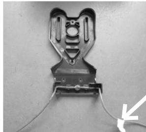
2. Heizkabelabdeckung mit Heizkabel am hinteren Teil des Beckens aufsetzen
