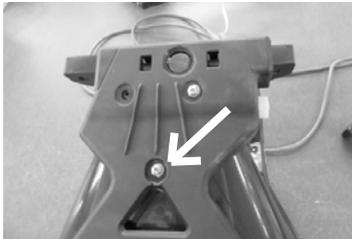
8. Unterlegscheibe und Schraube in die mittlere Befestigungsbohrung stecken und verschrauben. Siehe Pfeil!
